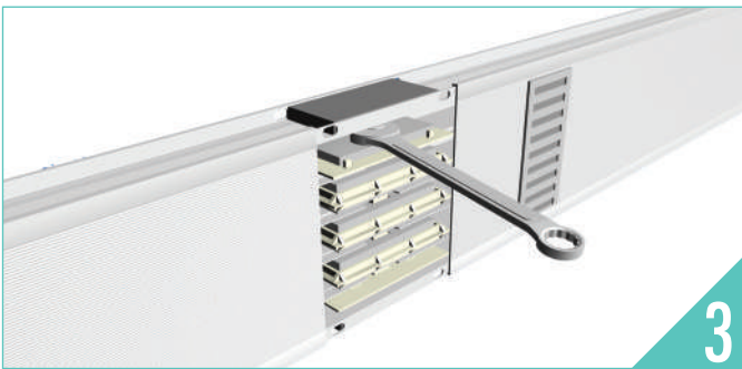
3) Ek elemanı civatasını, tork anahtarı ile belirtilen değerde sıkınız. 3) Tighten joint elements screw with torque wrench according to specified value.
