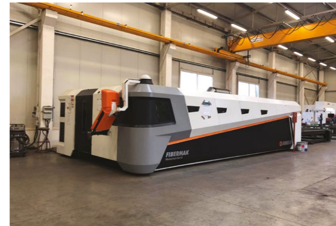
ERMAKSAN CNC Fiber lézer (maximális vágható táblaméret 6000x2000 mm)
