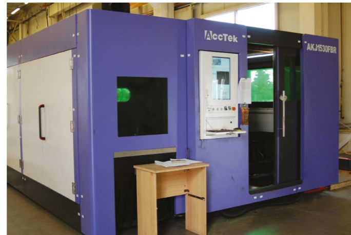
Acctek CNC Fiber lézer (maximális vágható táblaméret 3000x1500 mm)
